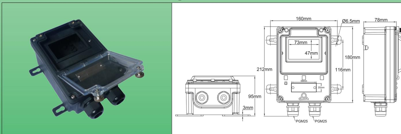
Consente il montaggio di un interruttore automatico tipo Merlin Gerin Multi 9 (UL, CSA, IEC) e delle gamme europee equivalenti Vigi C60 o C60 (72 mm di larghezza massima = quattro moduli da 18 mm), o dei controller elettronici descritti in questo catalogo.
