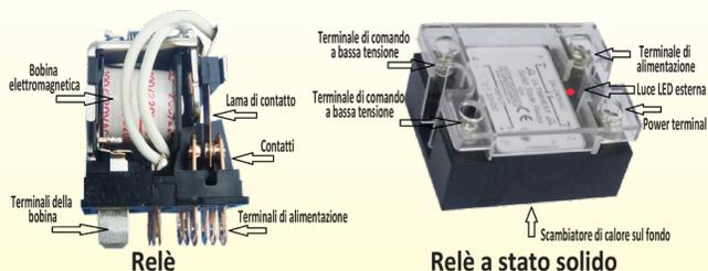
**Il relè o contattore elettromeccanico:** La bobina è costituita da un numero molto elevato di spire di un filo di rame molto sottile. Quando una corrente sufficiente attraversa la bobina, produce un campo magnetico che attrae la parte mobile e muove le linguette con i contatti elettrici. Quando la corrente non passa più nella bobina, i contatti tornano nella posizione iniziale grazie a una molla di reset.
