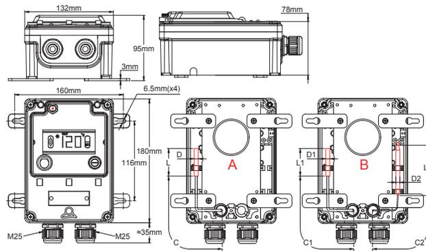
A: Modello a un sensore, solo controllo della temperatura.
