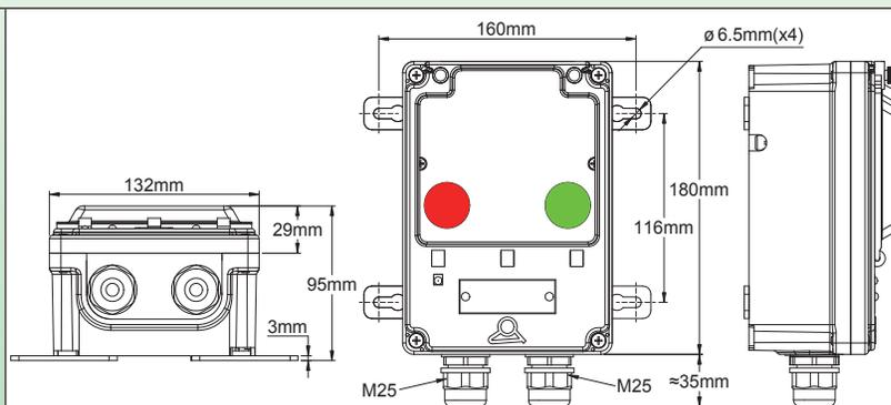
3 × 16A (AC1), 250V, morsettiera con 5 morsetti a vite da 2.5mm<sup>2</sup> e 5 morsetti a vite da 6mm<sup>2</sup>. Spia rossa per l'alimentazione e spia verde in uscita (250V), finestra trasparente.
