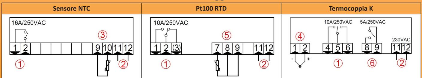
1: Uscita a relè; 2: Alimentazione 230V AC; 3: Sensore NTC; 4: Sensore a termocoppia K; 5: Sensore Pt100; 6: Uscita relè di allarme.
