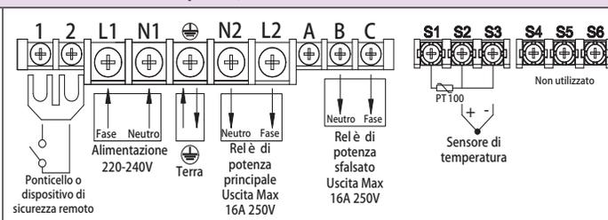
Circuiti a 3 poli, 2 uscite a relè sfalsate 3x16A 250V
