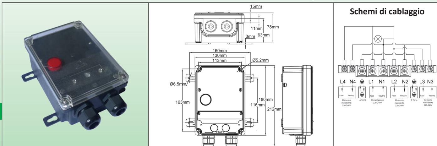
**Cablaggio:** alimentazione Neutro + Fase + Terra su una morsetteria da 6 mm<sup>2</sup> e uscite su 3 prese del circuito di riscaldamento da 1.5 o 2.5 mm<sup>2</sup>.
