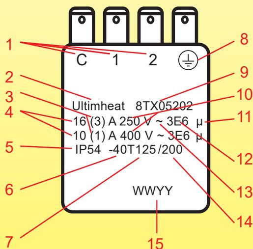
1: Identificazione dei morsetti adatti al collegamento di conduttori esterni e se sono adatti ai conduttori di linea o di neutro o a entrambi.
