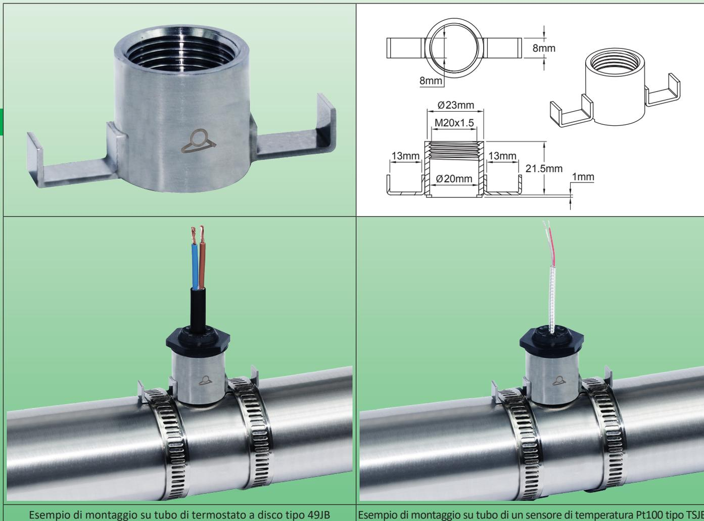
Esempio di montaggio su tubo di termostato a disco tipo 49JB
